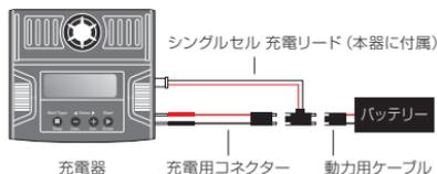
※シングルセル充電リードは充電器コードと動力用ケーブルの間に接続しリードから出ているバランスケーブルを充電器に接続してください。
