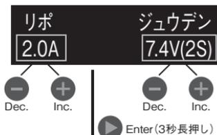
画面上段、左側に充電するバッテリーの種類、画面下段、左側には充電電流、右側には電圧(セル数)が表示されます。(Enter)ボタンを押す事で選択項目が移動しますので、(Dec.)/(Inc.)ボタンでそれぞれの数値を設定することが可能です。ご使用のバッテリーに合わせた設定が完了したら(Enter)ボタンを3秒間長押しする事で確認画面に変わります。
