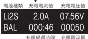
充電の表示画面に変わり充電を開始します。画面上段左から、電池種類とセル数、充電電流値、充電電圧値画面、下段左から、充電経過時間、充電電流量がそれぞれ表示されます。(Dec.)ボタンを押すことで、ユーザーセットアップで設定した一部の設定情報を確認する事が出来ます。また(Inc.)ボタンでセル毎の電圧を確認できます。
