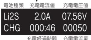
充電の表示画面に変わり充電を開始します。画面上段左から、電池種類とセル数、充電電流値、充電電圧値画面、下段左から、充電経過時間、充電電流量がそれぞれ表示されます。(Dec.)ボタンを押すことで、ユーザーセットアップで設定した一部の設定情報を確認する事が出来ます。また(Inc.)ボタンでセル毎の電圧を確認できます。
