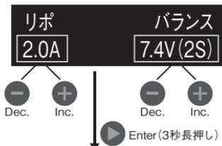
画面上段、左側に充電するバッテリーの種類、画面下段、左側には充電電流、右側には電圧(セル数)が表示されます。(Enter)ボタンを押す事で選択項目が移動しますので、(Dec.)/(Inc.)ボタンでそれぞれの数値を設定することが可能です。ご使用のバッテリーに合わせた設定が完了したら(Enter)ボタンを3秒間長押しする事で確認画面に変わります。
