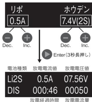
画面上段、左側に放電するバッテリーの種類、画面下段、左側には放電電流、右側にはセル数が表示されます。(Enter)ボタンを押す事に選択項目が移動しますので、(Dec.)/(Inc.)ボタンでそれぞれの数値を設定することが可能です。設定が完了したら(Enter)ボタンを3秒間長押しする事で放電が開始されます。
