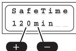
バッテリーパックの品質が低い場合やカット回路が故障した時などの過充電を防ぐために、充電を開始すると安全タイマーが自動的に開始されます。
