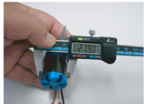
推奨モーター“Powers C2820-1200 ブラシレスモーター”の直径は28mmですので、加工を行わないとモーターが干渉してしまいます。
