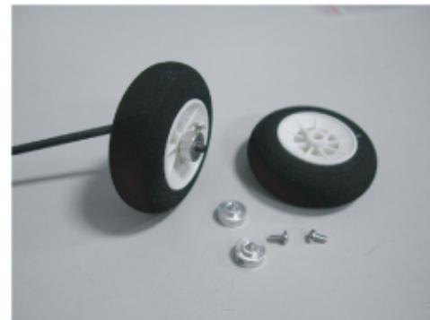
①主脚にタイヤを取り付けます。タイヤの両端をホイールカラーで挟み込み固定します。ホイールカラーは段差のある方を内側にします。
