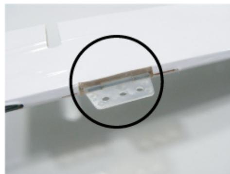
①ヒンジをフラップに接続します。まず上記写真のようにフラップのヒンジが刺さる部分に軽く溝を掘ります。こうすることにより、主翼とフラップの隙間が無くなり主翼効率を向上させます。
