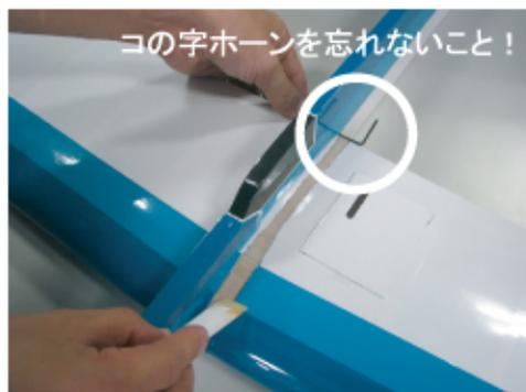
⑦1回分の30分エポキシを用意し、混ぜます。主翼とフラップ用コの字ホーンを胴体に差し込みます。設定した位置の手前まで差し込んだ状態で、胴体の主翼用の穴の内側、主翼の胴体との接触部にエポキシを盛ります。フラップ接続用ワイヤーも一緒に、主翼を所定の位置まで差し込みます。フラップ接続用ワイヤーにはエポキシがつかないようにします。もし心配ならばワイヤーの中央付近を石油系のジェルで覆っておけばエポキシが浸透しません。③でおこなったように、主翼の中心を調整します。主翼が胴体に垂直になるように気をつけます。小さなバルサ片、ペーパータオル、アルコールなどで、はみ出たエポキシを取り除きます。次のステップに進む前に、エポキシを完全に硬化させます。
