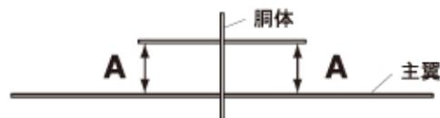
③スタビライザーを差し込みます。まず、目視でかまわないので出来るだけ中心に来るようにスタビライザーを取り付けます。飛行機のおよそ3m後ろから目視して、スタビライザーと主翼が平行かどうかを見ます。もし平行でない場合、小さなおもりをスタビライザーの高くなっている方の面に置いてみて、平行になるかどうかを見てみます。おもりの重さが足りない場合、スタビライザーを取り外し、スタビライザー用の穴の内側を少しずつ磨く、削るなどして、スタビライザーが主翼に平行になるようにします。
