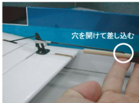
⑪木製プッシュロッドに穴を開け、写真のようにプッシュロッドの折り曲げた部分を木製プッシュロッドに開けた穴に差し込みます。
