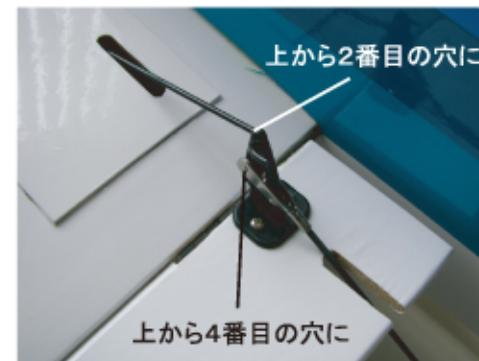
⑧ベルクランクから出ているリンクージをホーンの上から2番目の穴に差し込みます。更にプッシュロッドの先端をホーンの上から4番目の穴に差し込みます。
