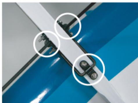
③主脚をランディングパーツで写真のように3箇所固定し取り付けます。
