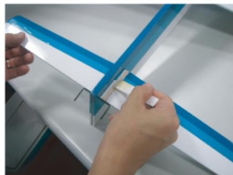
⑧1回分の30分エポキシを用意し、混ぜます。スタビライザーのフィルムを切り取った部分にエポキシを盛ります。スタビライザーを所定の位置まで差し込みます。小さなバルサ片、ペーパータオル、アルコールなどではみ出たエポキシを取り除きます。エポキシが硬化する前に、③～⑥でおこなったように、スタビライザーの中心を調整することを忘れないでください。
