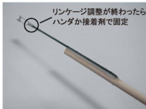
⑫プッシュロッドを木製プッシュロッドに取り付ける位置が確定したら、エポキシで固定します。エポキシが完全に固まったら収縮チューブで補強をしてください。リンケージの調整が終わった後は、写真で指示した箇所をハンダか接着剤で固定します。
