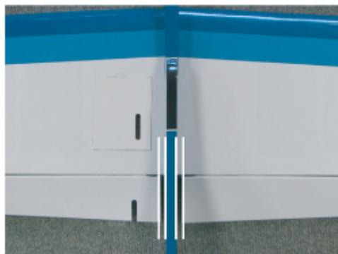
④主翼を胴体に差し込みます。このとき、主翼フラップの隙間が左右均等になるようにします。
