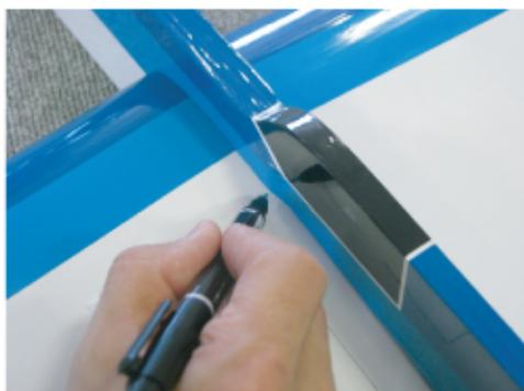
⑤主翼のセンターの位置が調整できたらフェルトペンやマーカーなどで主翼と胴体の接続部をなぞりマーキングします。
