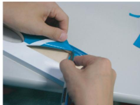
飛行機を組み立てる下準備として、まずカッターナイフ等で機体のフィルムのトリミングを行います。カッターの刃で機体を傷つけないように慎重に行ってください。
