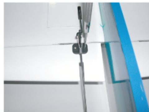
⑥ピンバイス等でフラップにネジ穴を開け、ホーンを取り付けます。ホーンの取り付け箇所は、ホーンの穴がヒンジの位置と一直線になるように設置して下さい。
