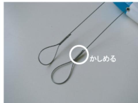
②ワイヤーの先端を写真のように輪っかにして、かしめます。
